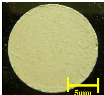
図 5 錠剤化したかんぴょう粉末試料 (直径 15mm, 厚さ 2mm)
